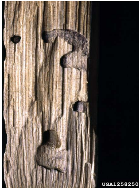
Abb4. Austrittsloch eines ausgewachsenen Bockkäfers (3)
